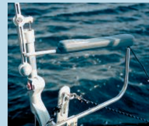
KOMBINIERT man die Windsteueranlage mit einem Schubstangenautopiloten, hält die Yacht auch dann Kurs, wenn nur ein leises Lüfterl weht. Pendelruderanlagen beispielsweise arbeiten erst ab zwei Knoten Fahrt durchs Wasser
